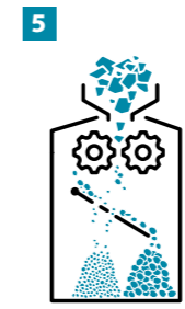
Aufbereitung von Betonabbruch im EBIREC
